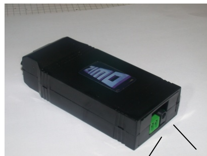
Anschluss Update-Gleis Betriebskontroll-LED's hinter der Buchse für Netzgerät
