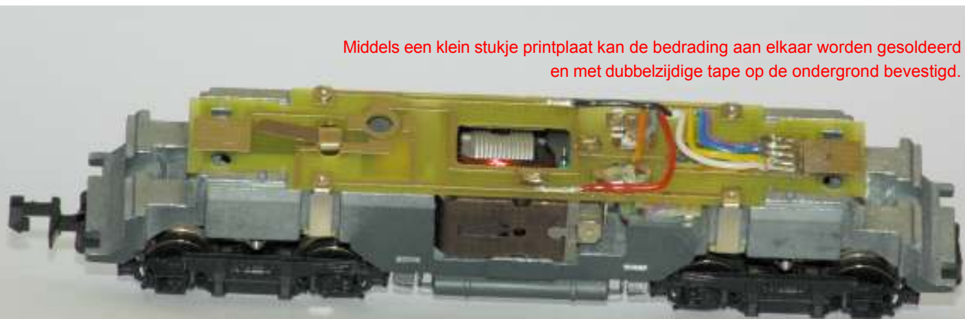
De printplaat weer op z'n plaats op het locframe.
