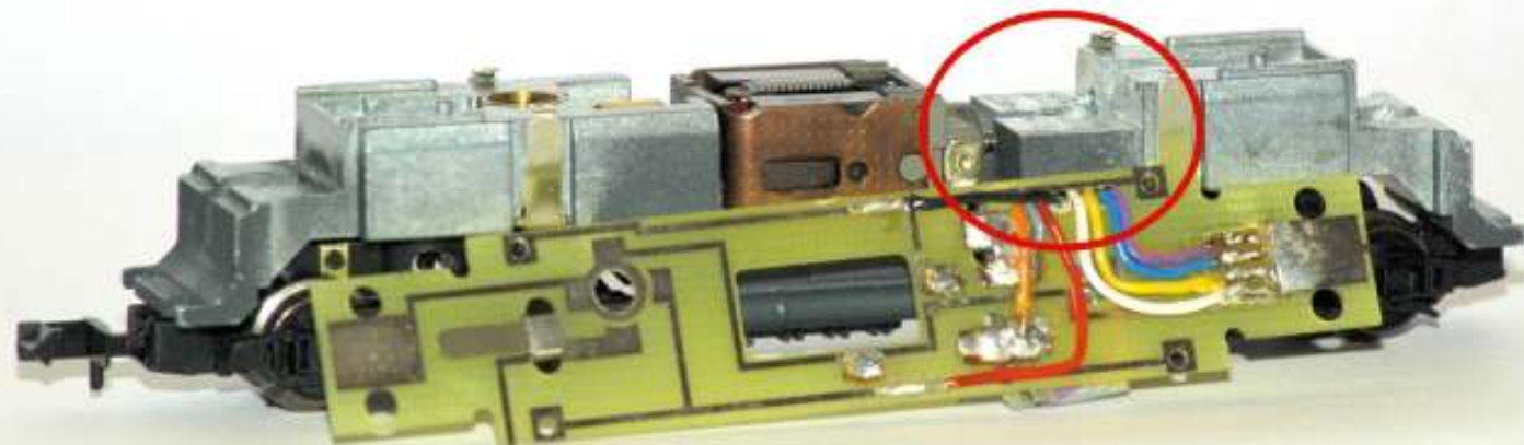
In de printplaat ter plaatse van de decoder een sleufje frezen t.b.v. de bedrading.
