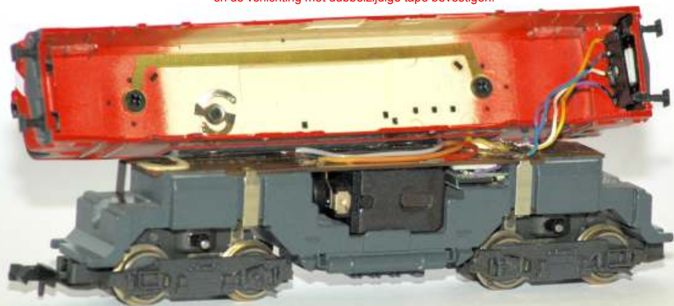
De bedrading kleur-op-kleur met elkaar verbinden. Aan de buitenzijde de koplampen voorzien van een nieuw glaasje m.b.v. Kristal Klear.
